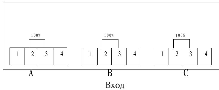
Если входное напряжение на 10% превышает номинальное значение, перемычку можно сместить влево на один шаг, схема подключения станет такой:
