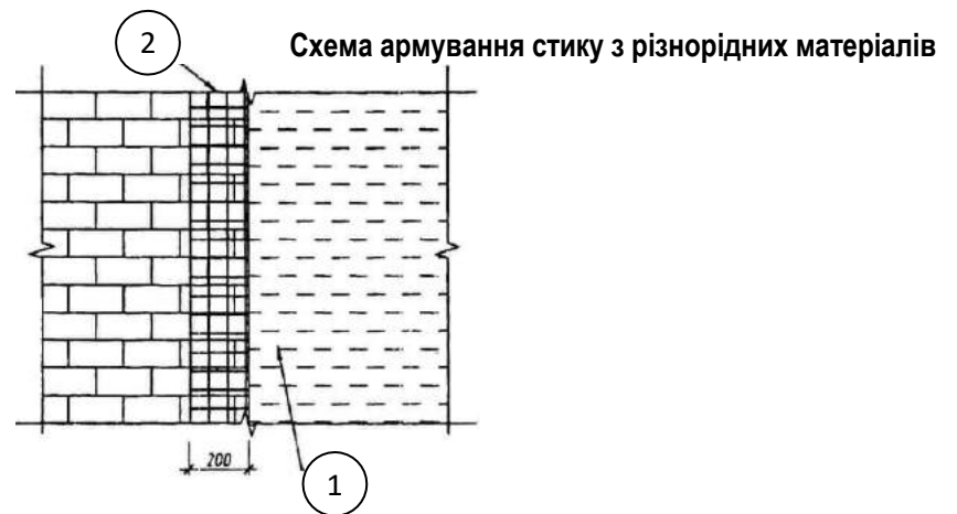
Рисунок 5: 1 - дротяна комбінована сітка; 2 - видалити картон на ділянці нахльсту.
