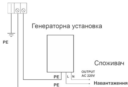
Рисунок 8. Схема заземлення виробу.
