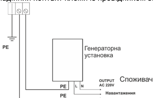
Рисунок 5. Схема заземлення виробу.
