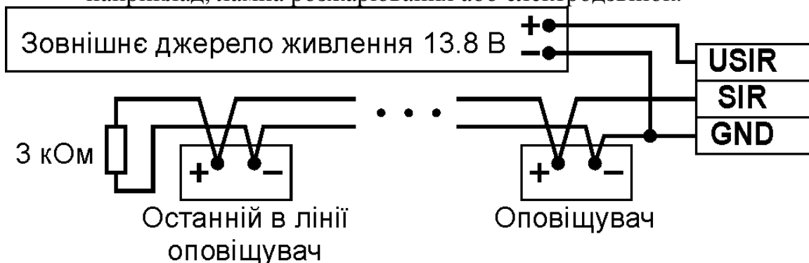
Рисунок 6.2.5 – Підключення оповісвачів від внутрішнього джерела живлення. Оповісвач, приєднаний через діод, має низький вхідний опір: наприклад, лампа розжарювання або електродзвінок.
