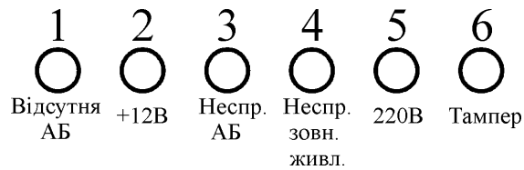
Рисунок 5.4 – Розширена індикація несправностей живлення для 8П.1
