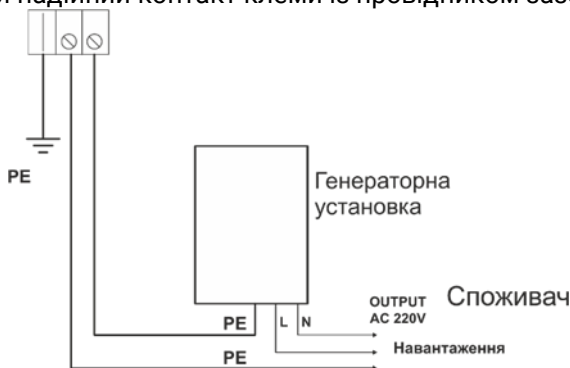
Рисунок 5. Схема заземлення виробу.
