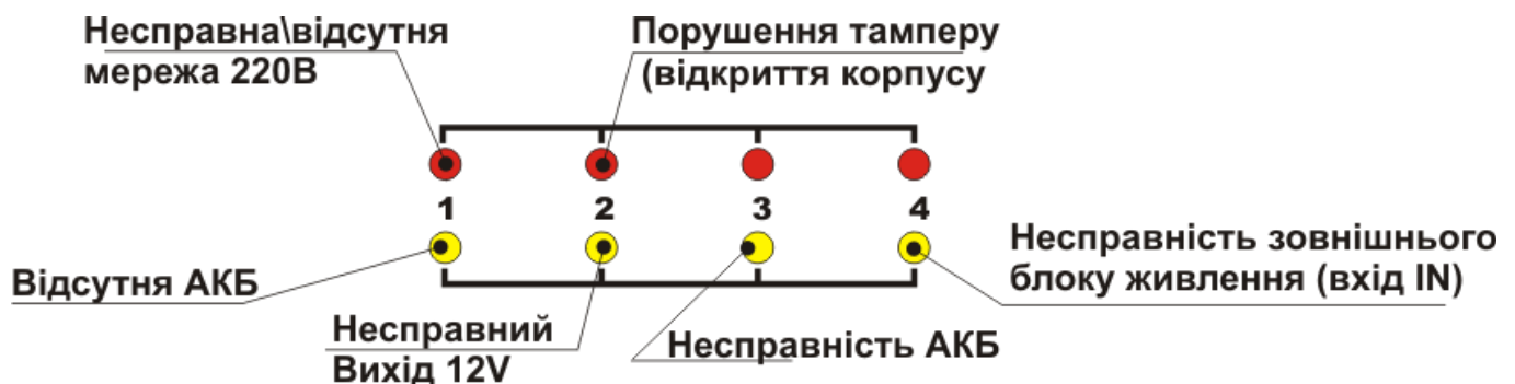
Рисунок 5.1 – Розширена індикація несправностей живлення для Тірас-4П.1
