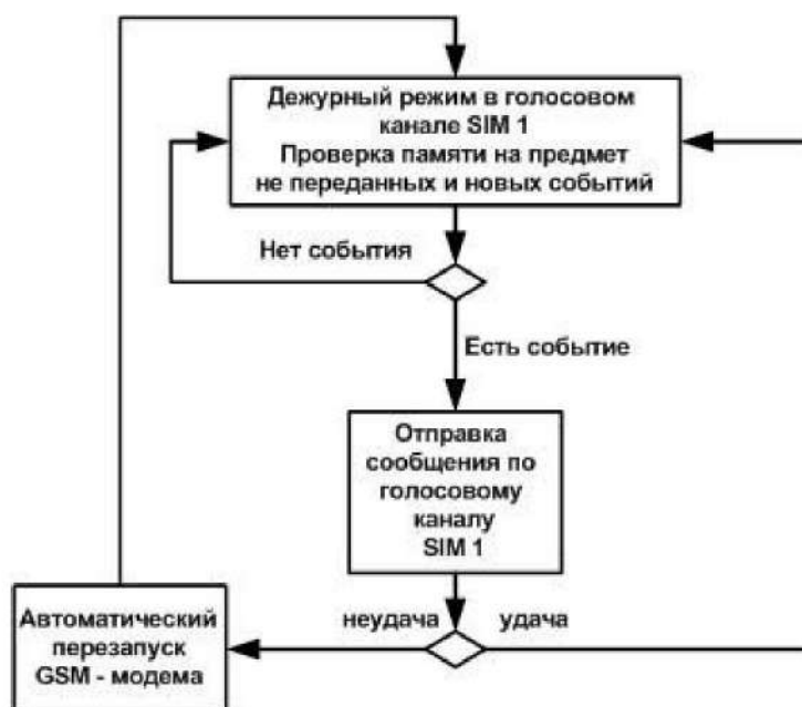
Рисунок 6. Использование голосового канала связи для одной SIM-карты
