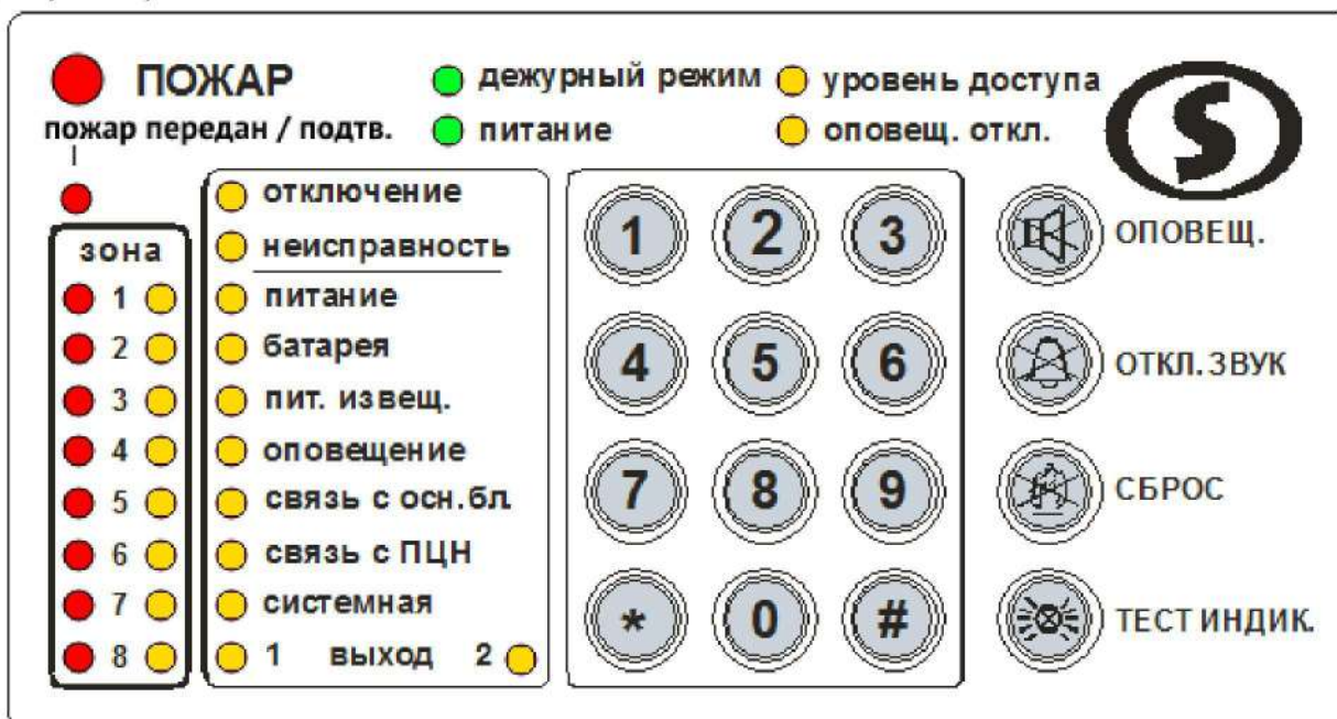
Рисунок 7. Внешний вид лицевой панели УИУ «Линд-Р»
