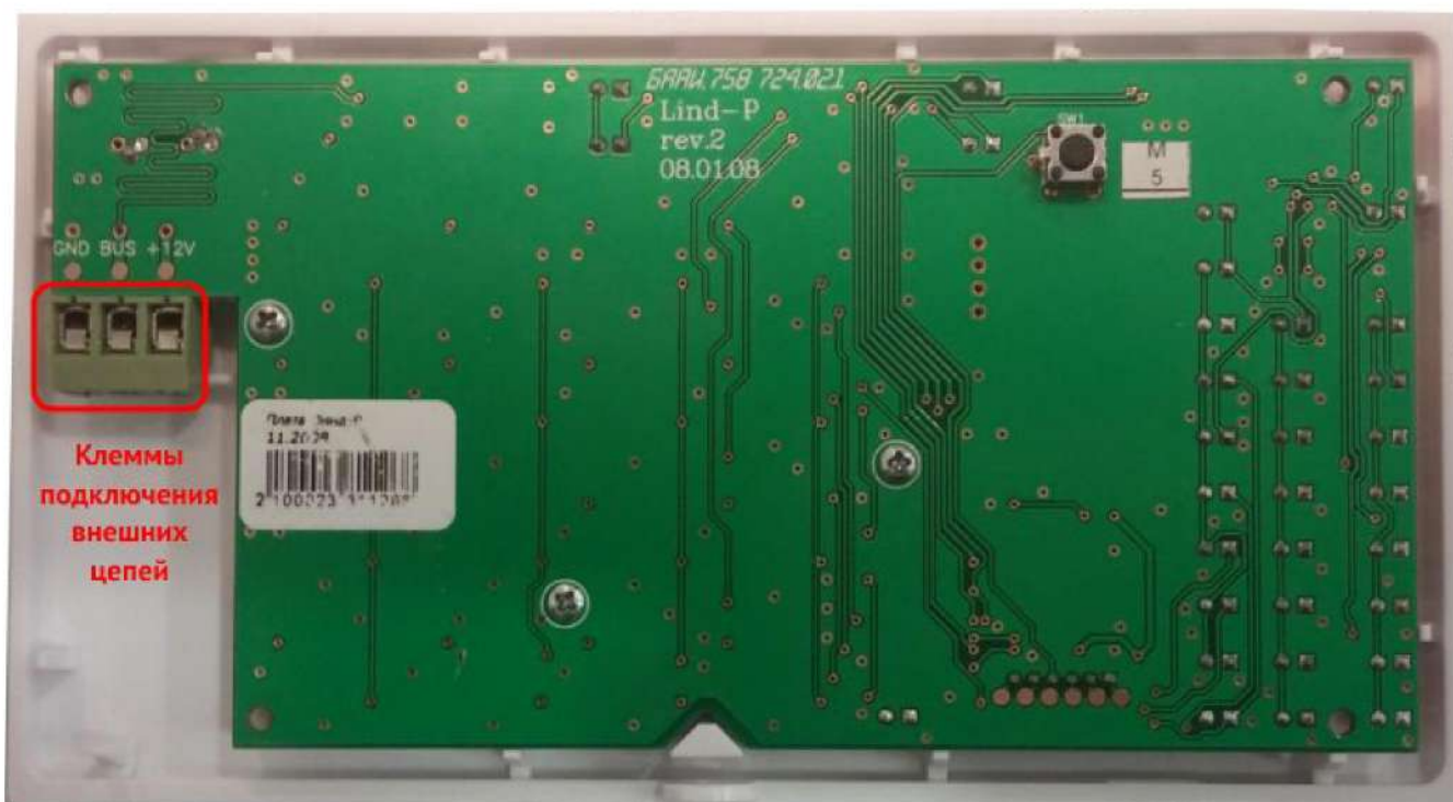
Рисунок 8. Плата УИУ (с обратной стороны)
