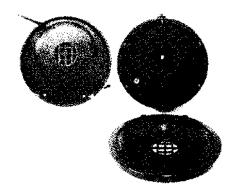
2. Открутите шесть винтов, чтобы снять крышку, чтобы отсоединить сборку на печатной плате, двигатель и батарею.
