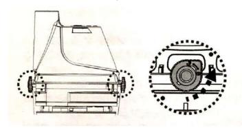
2. Установите задний корпус на плоскую поверхность (вверх дном, кнопка ВКЛ/ВЫКЛ питания направлена вверх). Совместите и сдвиньте защелку зарядного устройства в боковой паз на нижней поверхности заднего корпуса, пока защелка не зафиксируется. Убедитесь, что контактные пластины контактируют надлежащим образом. Подключите гнездо наружного переходника к зарядному устройству на торце зарядного устройства.
