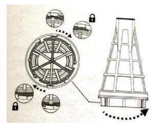
6. Для повторной установки прозрачного контейнера (с фильтровальным конусом внутри) на задний корпус убедитесь, что кнопки с фиксацией (на каждой стороне) установлены в положение при расфиксации. Совместите поднятые дужки на обеих сторонах прозрачного контейнера с кнопками с фиксацией и поверните каждую кнопку по часовой стрелке, пока они не будут указывать на красную точку, чтобы зафиксировать сборку.
