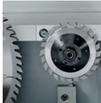
■ **Vorritzer (Option).** Der Vorritzer ermöglicht ausrissfreie Unterseiten beim Sägen von beschichtetem Plattenmaterial. Die Höhen- und Seitenverstellung erfolgt manuell. Nach der Höheneinstellung ist der Vorritzer per Hebel schnell absenkbar. Die eingestellte Höhe ist wieder einsetzbar, indem der Absenkhebel zurückgestellt wird. Das Vorritzaggregat hat eine Antriebsleistung von 0,75 kW bei 8 200 U/min.
