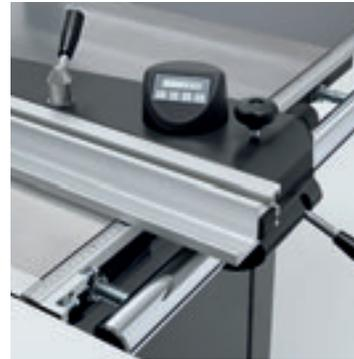
■ **DIGIT X.** Digitale Schnittbreitenanzeige des Parallelanschlags mit manueller Feineinstellung. Dieses elektronische Mess-System garantiert die genaue, schnelle Einstellung des Parallelanschlags. Wiederkehrende Schnittwerte sind exakt reproduzierbar und in der DIGIT X Anzeige abzulesen. Das System arbeitet verschleißfrei und ist staubunempfindlich. Beim Umlegen der Anschlagsschiene in die aufrechte bzw. flache Position erfolgt die Maßkorrektur automatisch.
