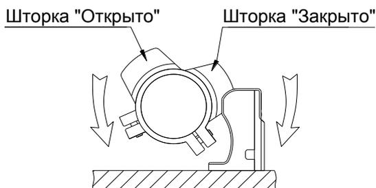
В случае необходимости настройки концевых выключателей открутить винт М4 на соответствующей шторке того выключателя, повернуть его на оси на требуемый угол и зажать винт.
