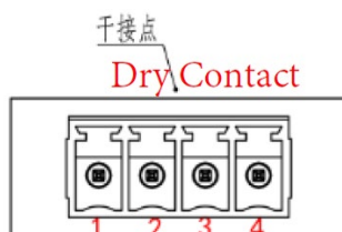
Таблиця 2-9 Визначення інтерфейсу сухого контакту
