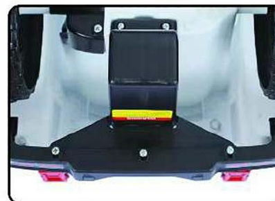
3. Встановіть задню опору і затягніть 5 гвинтів
