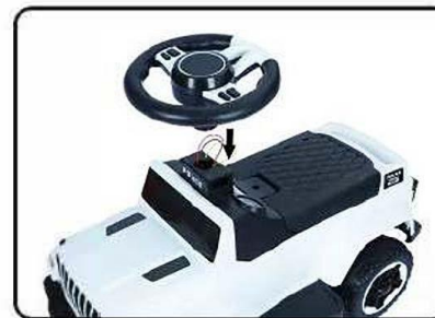
5. Підключіть лінію, встановіть кермо і вкрутіть гвинт
