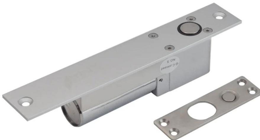
YB-100+ - врізний електроригельний замок для системи контролю доступу. Електроригельний замок призначений для внутрішнього встановлення як у дверну коробку (раму), так і в самі двері. Підходить для металевих, пластикових, металопластикових або дерев'яних дверей. Оснащений вбудованим таймером затримки закриття 0, 3, 6 сек. (перемикається перемичкою на замку).
