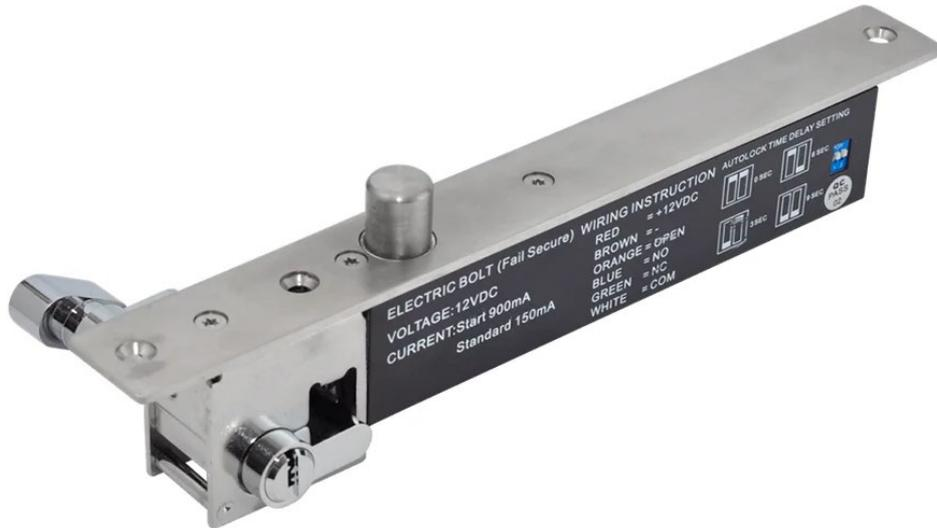
YB-600+ - врізний електроригельний замок для системи контролю доступу. Електроригельний замок призначений для внутрішнього встановлення як у дверну коробку (раму), так і в самі двері. Підходить для металевих, пластикових, металопластикових або дерев'яних дверей. Оснащений вбудованим таймером затримки закриття 0, 3, 6 або 9 сек. (перемикається перемичками на замку).
