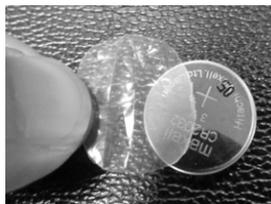
Снимите резиновую пленку с поверхности батарейки.
