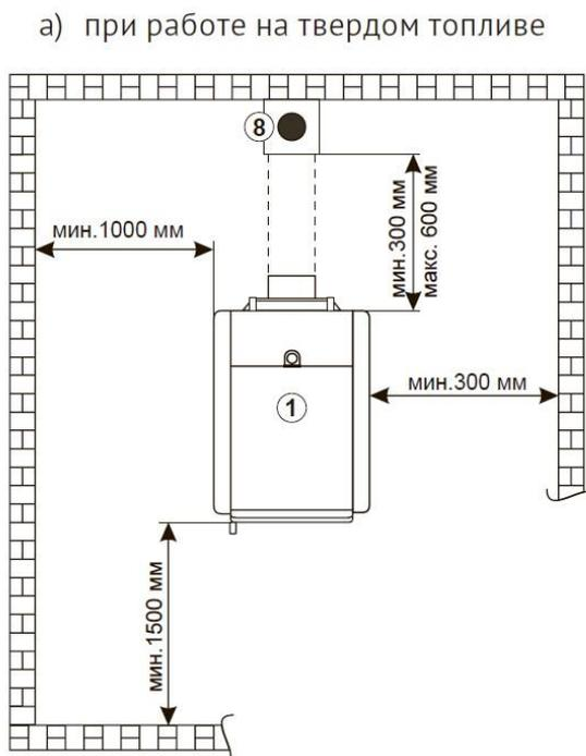
Котел должен устанавливаться в положении, позволяющим выполнять правильное соединение с дымоходом (см. п.4.3), а также обслуживание котла, контроль во время работы, очистку и ремонт.
