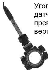
Угол наклона датчика не должен превышать 45° от вертикали
