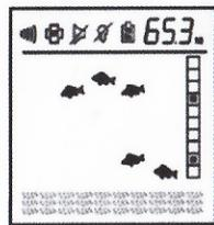
ДЛЯ ОПРЕДЕЛЕНИЯ ГЛУБИНЫ НАХОЖДЕНИЯ РЫБ ИСПОЛЬЗУЙТЕ "ИНДИКАТОР ГЛУБИНЫ", ОДНО ДЕЛЕНИЕ ИНДИКАТОРА СООТВЕТСТВУЕТ 10 МЕТРАМ ГЛУБИНЫ.
