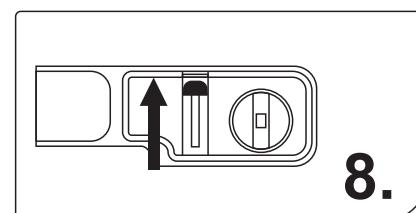
8. Підніміть ручку-утримувач для газового балона
