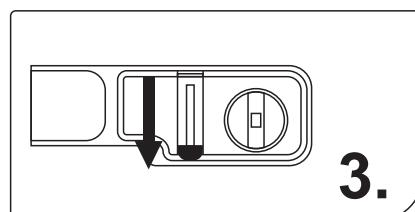
3. Опустіть ручку-утримувач для газового балона
