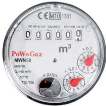
Указательно-барабанный механизм, который взаимодействует с передатчиками NK и NO. Счётчик оснащён элементом оптической передачи данных и размещён в герметическом пластмассовом корпусе.
