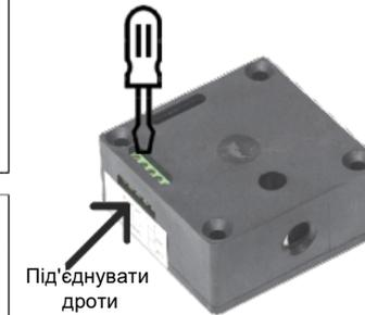
Ліворуч від сторони отвору ригелю, на бічній частині пристрою є контактна колодка. Блок живлення (дроти сигналу відкриття) повинен бути підключений до двох контактів ліворуч (червоний дрот має бути під'єднано до +12 В постійного струму, а чорний – до GND, або '—'), а 3 контакти праворуч із ними використовуються для зворотного зв'язку (NC/NO/C).
