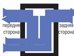
Двухступенчатая конструкция Исполнение для последовательного нагрева воды в двух ступенях (моноблок) Схема потоков – двухступенчатый водонагреватель
