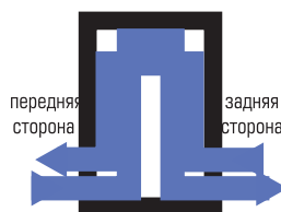
Двухходовая конструкция Применяется для обеспечения большей термической длины взаимодействия двух сред Схема потоков – двухходовая
