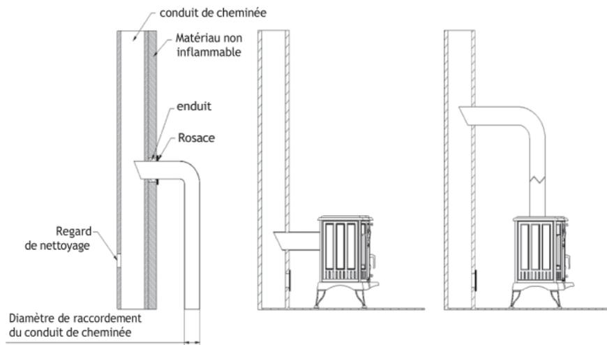
Le poêle indépendant doit être posé sur un sol non inflammable avec une portance suffisante.
