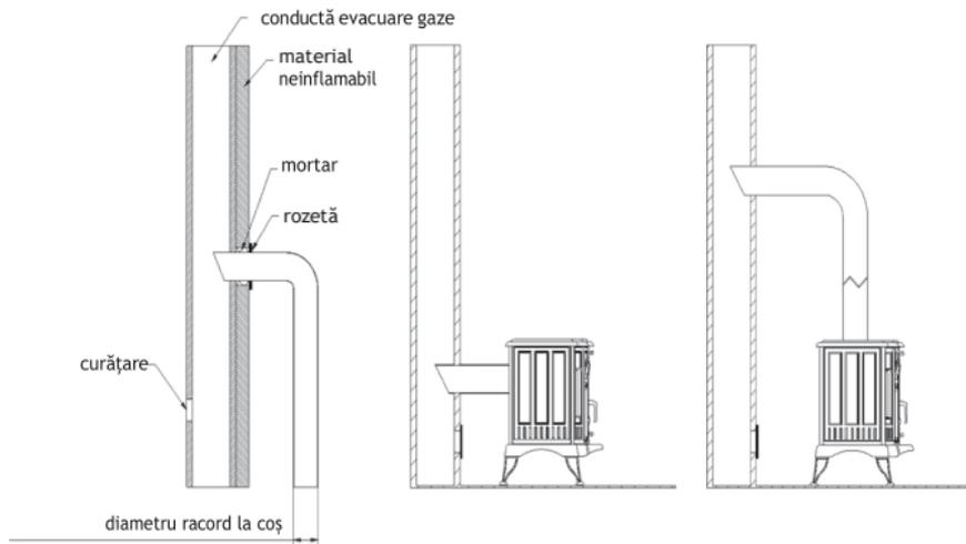
soba de sine stătătoare trebuie amplasată pe un suport ignifug cu o capacitate portantă corespunzătoare.
