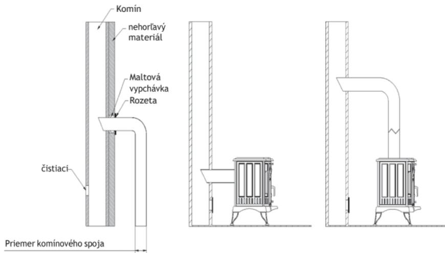
samostatné krbové kachle by sa mal umiestniť na nehorľavý podstavec s dostatočnou nosnosťou.
