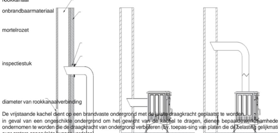
De vrijstaande kachel dient op een brandvaste ondergrond met de juiste draagkracht geplaatst te worden. In geval van een ongeschikte ondergrond om het gewicht van de kachel te dragen, dienen bepaalde werkzaamheden ondernomen te worden die de draagkracht van ondergrond verbeteren (bv. toepassing van platen die de belasting gelijkmatig over grotere oppervlakte kunnen verdelen).
