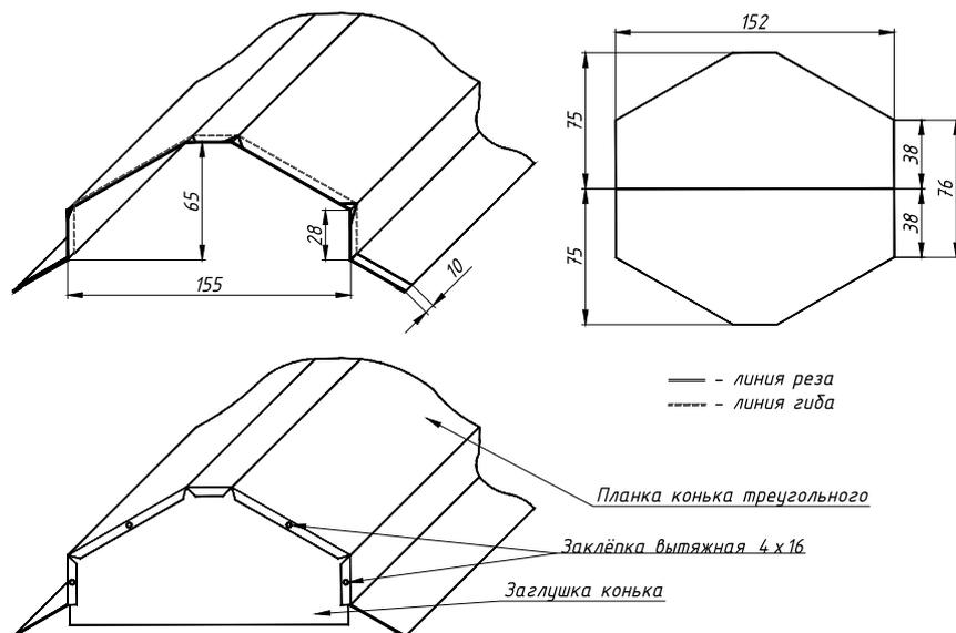
Гидроизоляция пересечения скатов на ребре у вальмовой или шатровой кровли выполняется аналогичным образом. Отличие состоит в отсутствии вентиляционных зазоров и герметизации стыка универсальным уплотнителем.
