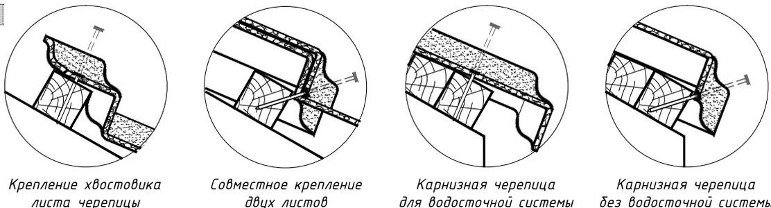
С целью предотвратить соскальзывание гвоздя в процессе прибивания, в носовой части листа черепицы **QueenTile®** предусмотрена отбортовка (**рисунок 20**). Она также предаёт повышенную жёсткость карнизной части листа.
