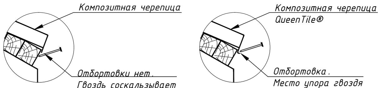
Крепление листа композитной черепицы **QueenTile®** следует начинать сверху. Закрепите лист в коньковой части 1-2 гвоздями перпендикулярно плоскости ската (**рисунок 19**). Впоследствии места крепления закроются верхним листом. Окончательно выровняйте монтируемый лист по уже уложенным либо по карнизу. Зафиксируйте лист в нескольких точках по краям. Дальнейший монтаж ведётся от краёв листа к центру.
