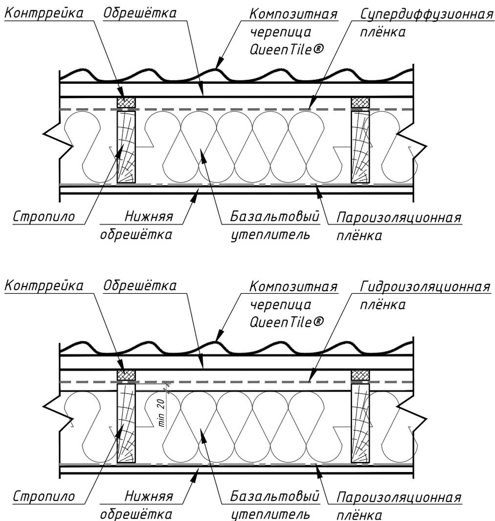
При монтаже пленок на фронтонном свесе всегда оставляйте запас от предполагаемых торцов обрешетки. После фиксации на фронтонном бруске, лишние края обрезаются. Также уложите плёнку между обрешёткой и кирпичной/бетонной стеной для защиты обрешётки.
