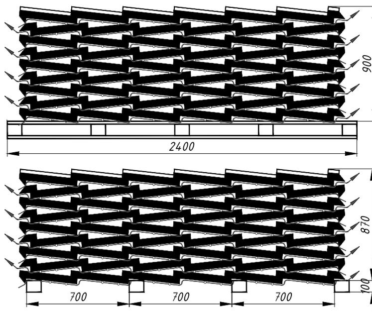
При резком перепаде температуры, например, при разгрузке в условиях пониженной температуры и последующем складировании в тёплом помещении, на элементах образуется конденсат. В этом случае, а также, если во время транспортировки, либо неправильного хранения на открытом воздухе произошло замораживание материала, влажные комплектующие необходимо сложить в штабеля с использованием дистанционных реек для обеспечения циркуляции воздуха.
