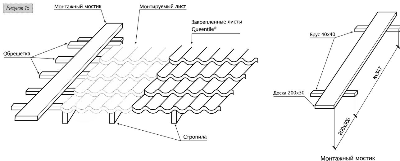
Благодаря специальной технологии, монтаж композитной черепицы **QueenTile®** осуществляется от карниза к коньку. Также появилась возможность вести устройство кровли крупноформатными листами, в отличие от других производителей, предлагающих композитную черепицу шириной в один тайл.
