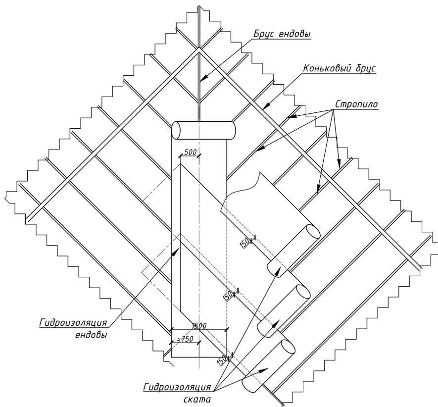
Отвод конденсата от мансардных окон и труб осуществляют при помощи желобков выполненных из гидроизоляционной плёнки. Для их устройства место будущего проёма обрамляют брусками контррейки. Полотнище плёнки перерезают крест-накрест и крепят к обрамлению, как показано на **рисунок 10**. Срежьте сверху проёма брусочки контррейки длиной 150...200 мм. Сделайте надрез гидроизоляционной плёнки над проёмом.
