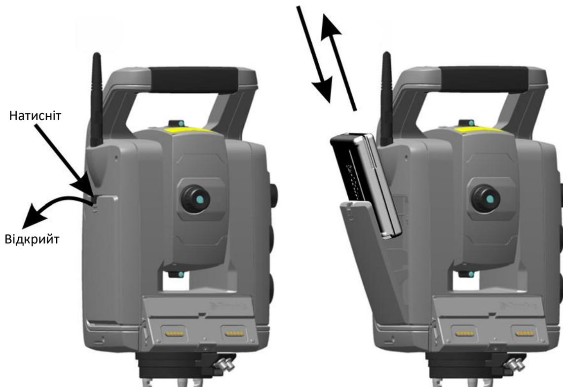
Малюнок 2.7 Установка та вилучення внутрішньої батареї
