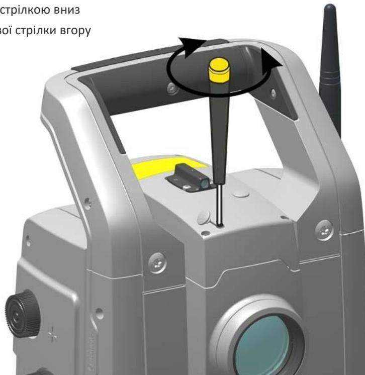
Малюнок 3.7 Юстування положення лазерного покажчика по вертикалі
