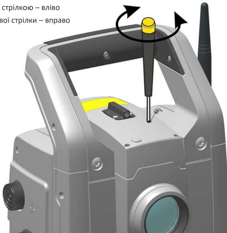
**Малюнок 3.8** Юстування положення лазерного покажчика по горизонталі
