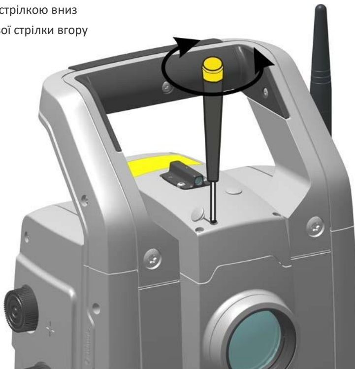
Малюнок 3.7 Юстування положення лазерного покажчика по вертикалі
