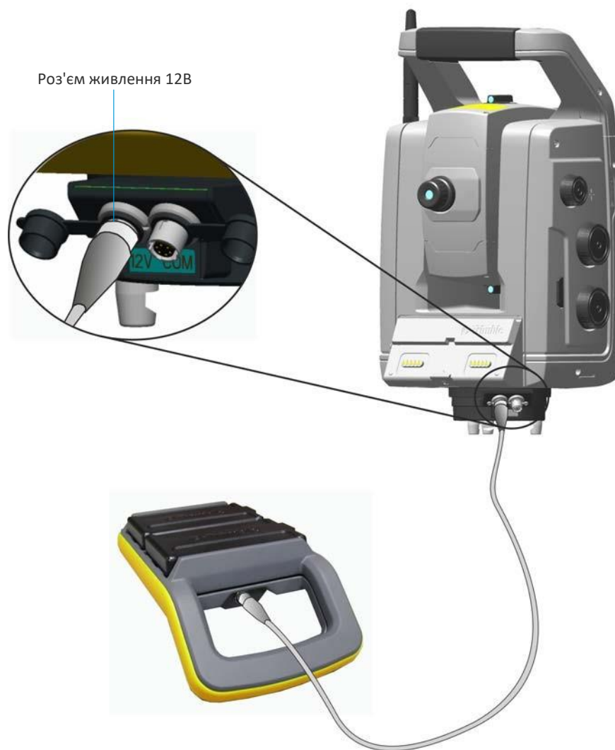
Малюнок 5.2 Підключення адаптера для кількох батарей
