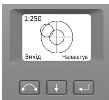
Малюнок 2.11 Сторінка нівелювання з електронним рівнем на дисплеї КП
