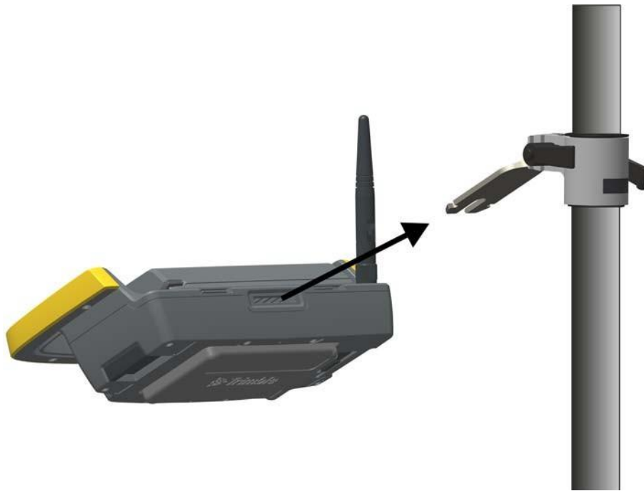
Малюнок 5.17 Приєднання тримача Trimble Robotic до адаптера стандартної віхи
