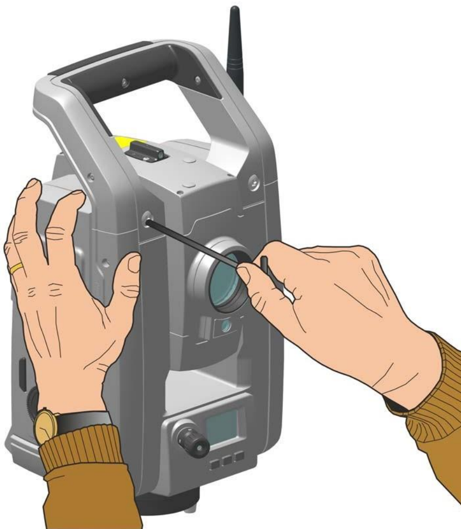
Малюнок 2.13 Від'єднання рукоятки інструменту
