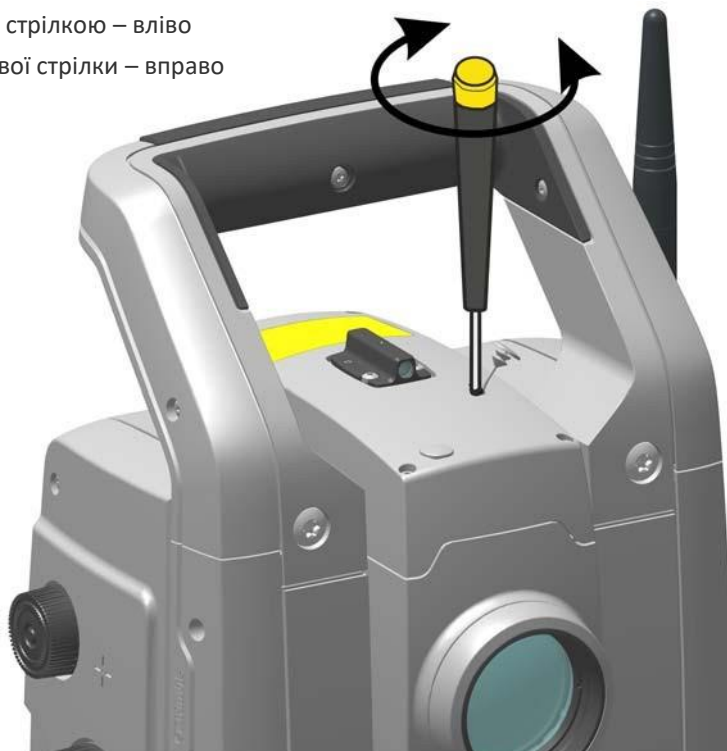
Малюнок 3.8 Юстування положення лазерного покажчика по горизонталі
