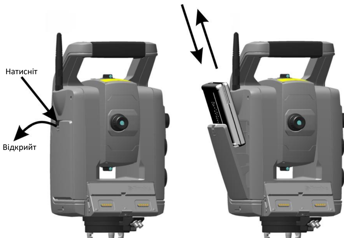
Малюнок 2.7 Установка та вилучення внутрішньої батареї
