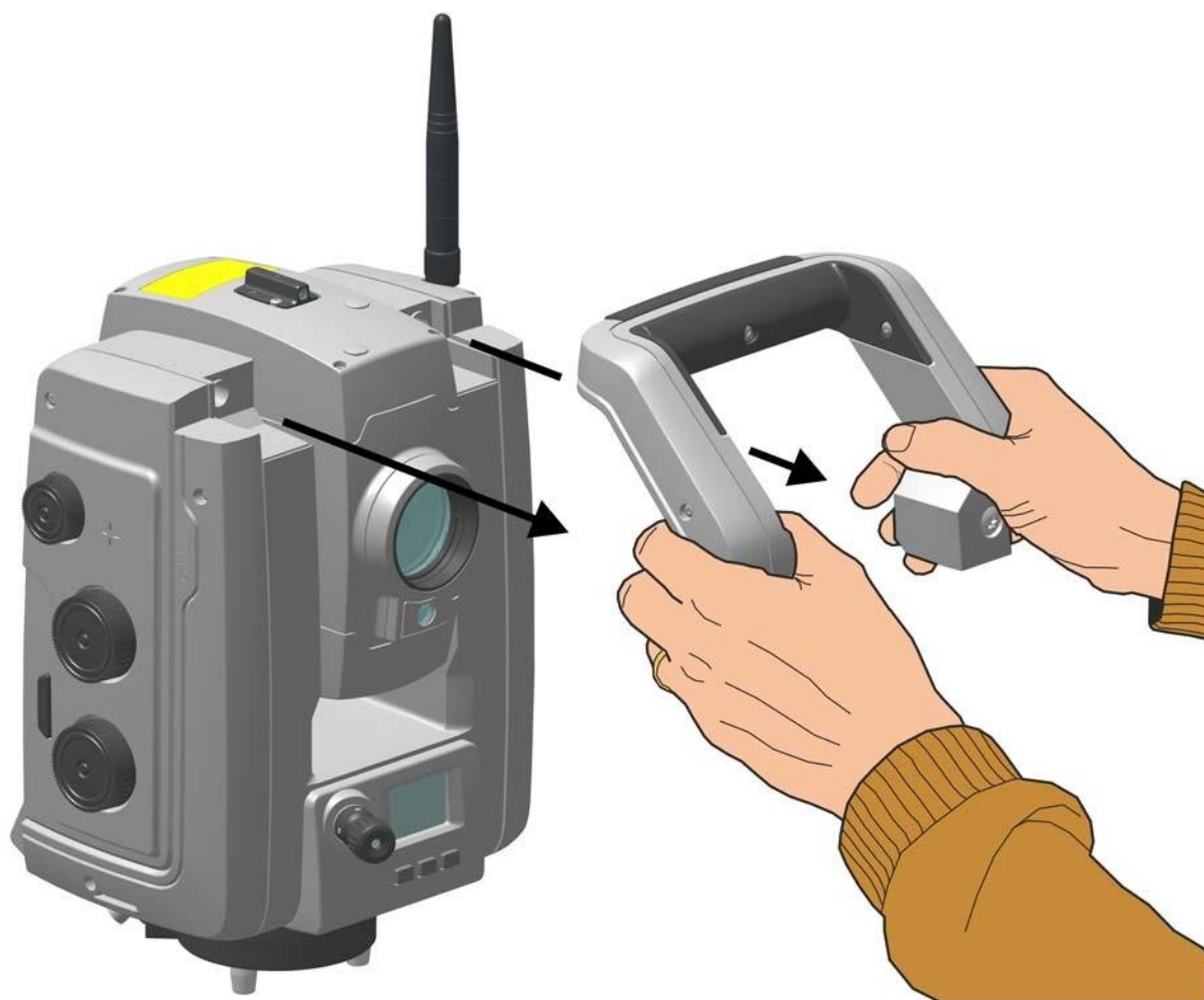
Малюнок 2.14 Від'єднання рукоятки інструменту
