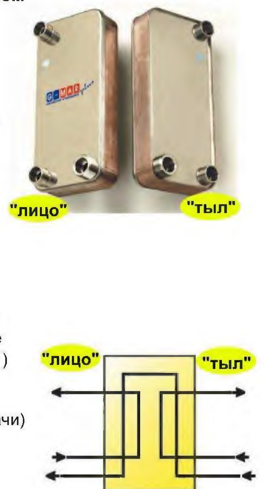
Изображение комбинации системы ЦО и прямого подогрева ГВС (дизайн с тыльным присоединением ТИП 6)
