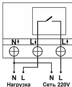
**!** Нулевой клеммник прибора не предназначен для подсоединения проводов рабочего ноля!
