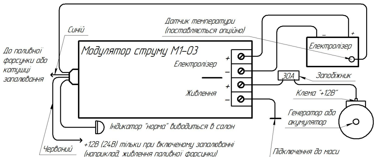
Мал. 3.3. Схема підключення модулятора до електролізера двома проводами.
