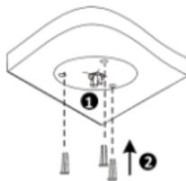
3. Поверніть корпус до суміщення міток, від'єднайте корпус.
