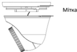
4. Проведіть хвостовий кабель через основу. Потім закріпіть основу на стелі за допомогою саморізів.
