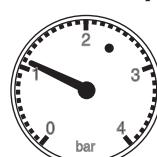
Отображает давление воды в отопительном контуре; данное значение не должно быть ниже 0,8/1 бар (при холодной системе).
