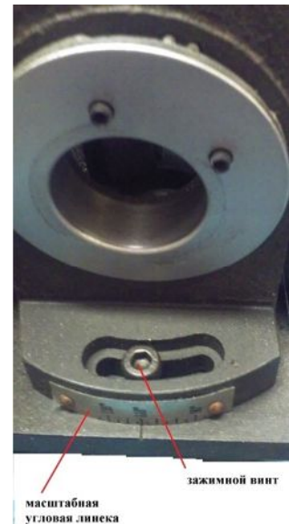
Рис. 4 Установка угла заточки
