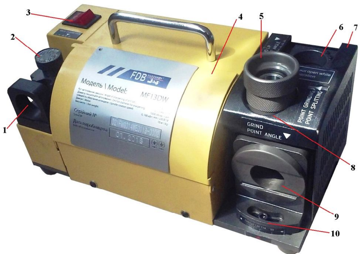
Мал. 2.2 Принципова будова верстата MF13DW:
