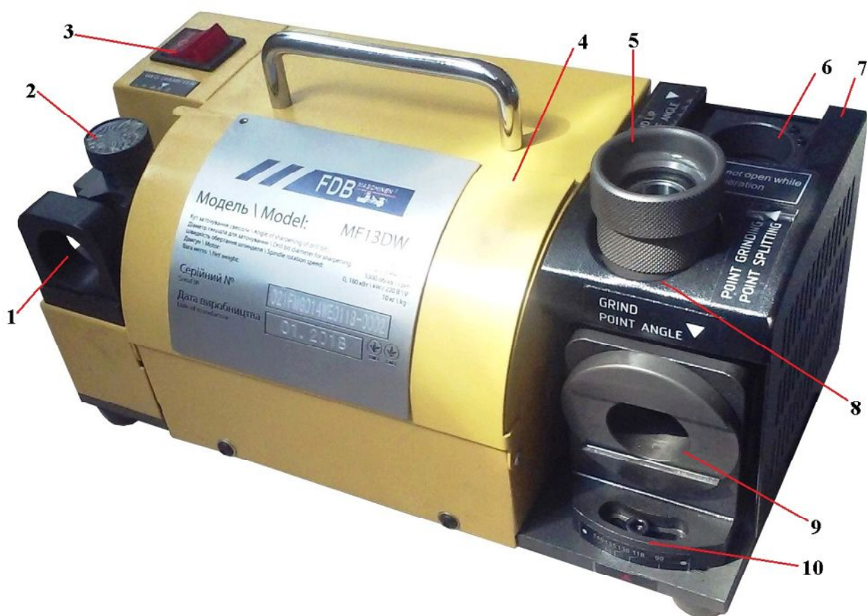
Рис. 2.2 Принципиальное устройство станка MF13DW:
