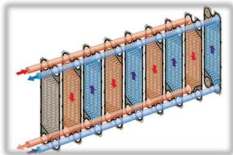
Между верхней и нижней зонами, расположена поверхность теплообмена пластины, которая имеет гофрированную поверхность, позволяющую создать турбулентный поток и интенсифицировать процесс теплообмена.
