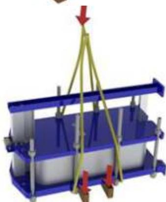
После поднятия т/о опустите его на 2 или более балки, чтобы было расстояние между полом и т/о. Можно использовать и другой материал вместо древесины, например, жесткий пластик и т.д. Когда вы аккуратно опустили т/о на пол, пожалуйста, следуйте следующему шагу по установке оборудования на рабочее место.
