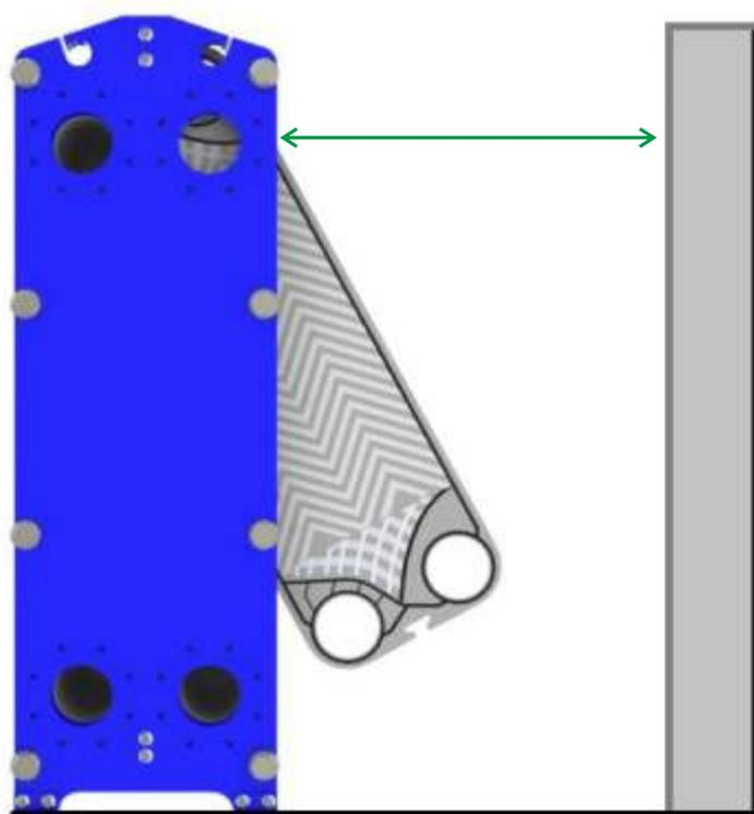
Расстояние между теплообменником и стеной должно быть достаточным для обслуживания и проведения сервисных работ.
