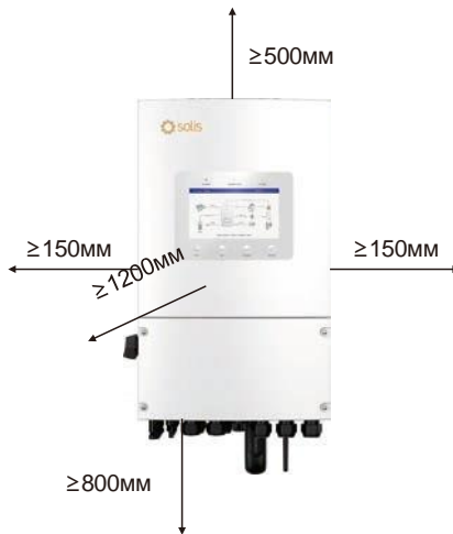
Малюнок 3.5 Монтажні зазори інвертора
