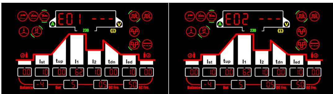
E01 и E02: Отображение ошибки перегрева
