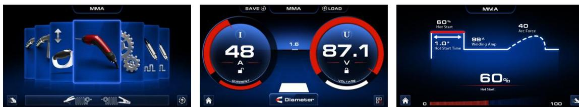
(4) Установите сварочный ток в соответствии с типом и размером используемого электрода в соответствии с рекомендациями производителя электрода.
