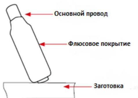
Ручные металлические дуговые (стержневые) электроды имеют сплошную металлическую проволочную сердцевину и флюсовое покрытие. Эти электроды обозначены диаметром провода и серией букв и цифр. Буквы и цифры обозначают металлический сплав и предполагаемое использование электрода.
