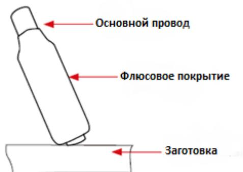
Покрытие на защитном электроде для электродуговой сварки называется флюсом.
