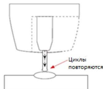
Скорость подачи проволоки преодолевает тепло дуги, и проволока снова приближается к работе, замыкается и повторяет цикл.
