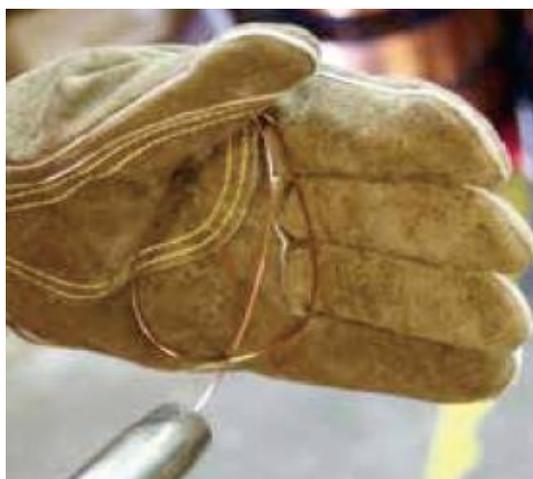
(8) Простая проверка правильности натяжения привода заключается в том, чтобы согнуть конец проволоки, удерживая его на расстоянии около 100 мм от вашей руки и позволяя ему врезаться в вашу руку, он должен закручиваться в вашей руке, не останавливаясь и не скользя по приводным роликам. Увеличьте натяжение, если оно проскальзывает.
