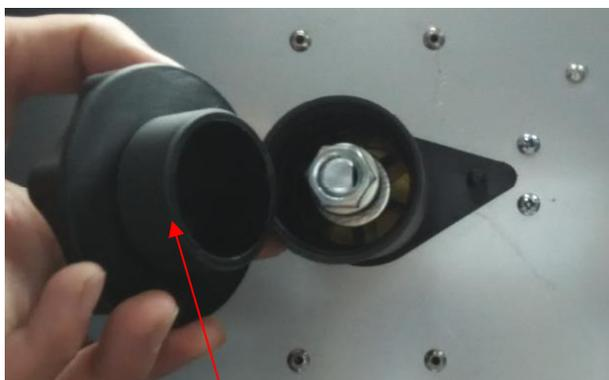
(1) Снимите стопорную гайку с катушки
