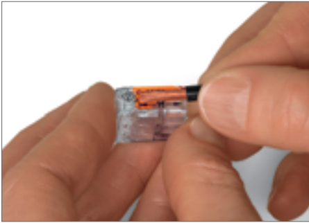
Зачистите изоляцию на длину 11 мм.
