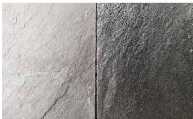
Панель А1 безпосередньо після розформовки | Панель А1 після 5 років під впливом погоди
