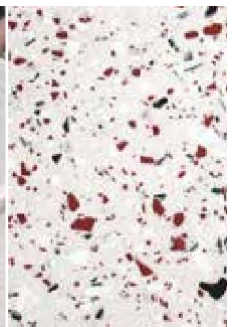
Відшліфуйте виріб після розформовки
