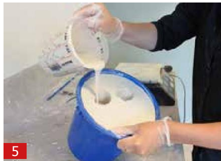
5 Повільно влийте трохи A1 уздовж краю в отвір. Нехай A1 протікає в усіх напрямках, щоб зменшити захоплення повітря. Поверніть/переверніть і постукайте по відру, щоб належним чином заповнив порожнини й не утворилися бульбашки повітря. Потім влийте решту A1. Знову постукайте по відру та заповніть A1 доверху
