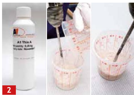
2 Додайте 2% Thix A (від загальної кількості А1) до А1 Смоли. Використовуючи Thix A, текстура А1 буде більш густою
