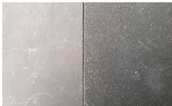
Панель А1 з піском безпосередньо після розформовки | Панель А1 з піском після 5 років під впливом погоди
