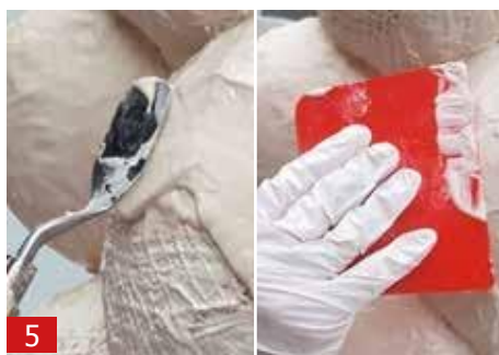
4 А1 можна наносити пензлем, валиком, шпателем або ракелем
