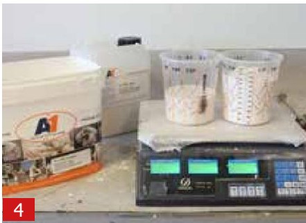
4 Зважте 1 частину A1 Смоли і 2 частини A1 Порошку і перемішайте. A1 готовий, як тільки зникнуть грудочки або повітряні бульбашки. Порада: обережно постукайте відром по твердій поверхні, щоб випустити повітря
