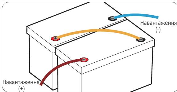
Після послідовного підключення напруга акумуляторної системи буде подвоєна відповідно до кількості підключених батарей.
