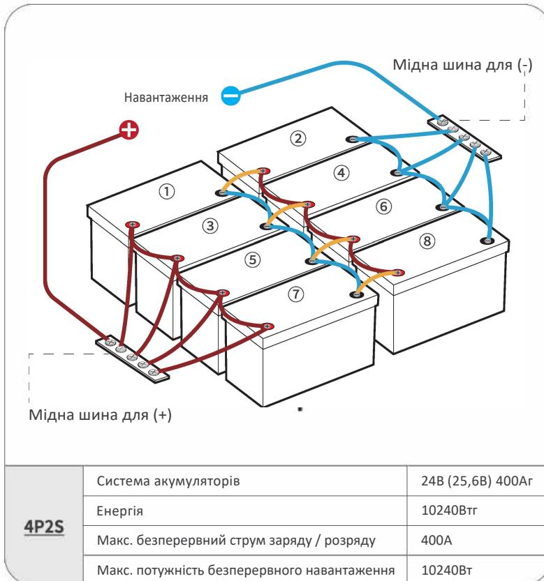
1) Оскільки (-) (1) / (3) / (5) / (7) з'єднано послідовно з (+) (2) / (4) / (6) / (8), будь ласка, не підключайте (-) (1) / (3) / (5) / (7) до (-) навантаження або (+) (2) / (4) / (6) / (8) до (+) навантаження, інакше система батарей не зможе з'єднатися послідовно.
