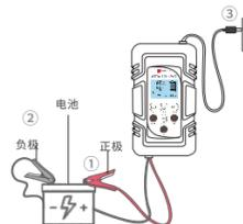
2、待机状态：插好电源后LCD数字显示屏闪烁显示表示在待机状态。
