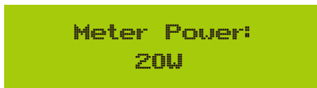
Рис. 7.36 Функція нульового експорту через увімкнення лічильника електроенергії
