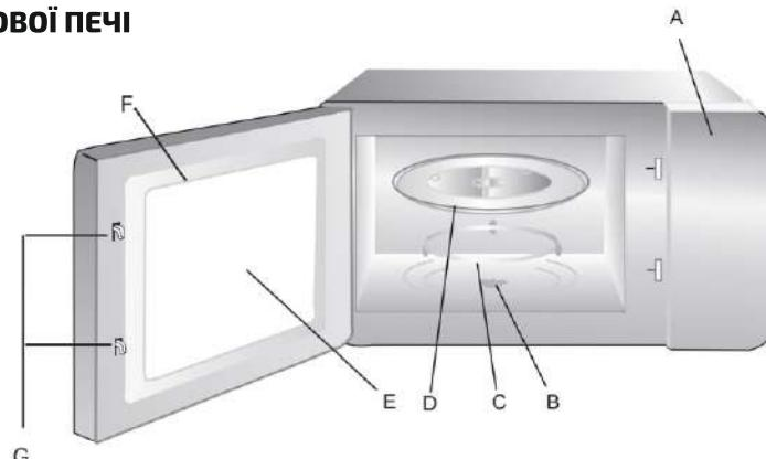
На поворотну вісі встановлюється скляний піднос. Під скляний піднос встановлюється роликова підставка, яка допомагає таці вільно обертатися. Обертання їжі під час роботи печі сприяє її рівномірному приготуванню. У камері печі з боку панелі управління розташована кришка хвилеводу. Мікрохвильова піч може почати роботу, тільки якщо її дверцята щільно закриті, що запобігає випромінювання мікрохвиль назовні.
