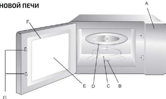
На поворотную ось устанавливается стеклянный поднос. Под стеклянный поднос устанавливается роликовая подставка, которая помогает подносу свободно вращаться. Вращение пищи во время работы печи способствует ее равномерному приготовлению.
