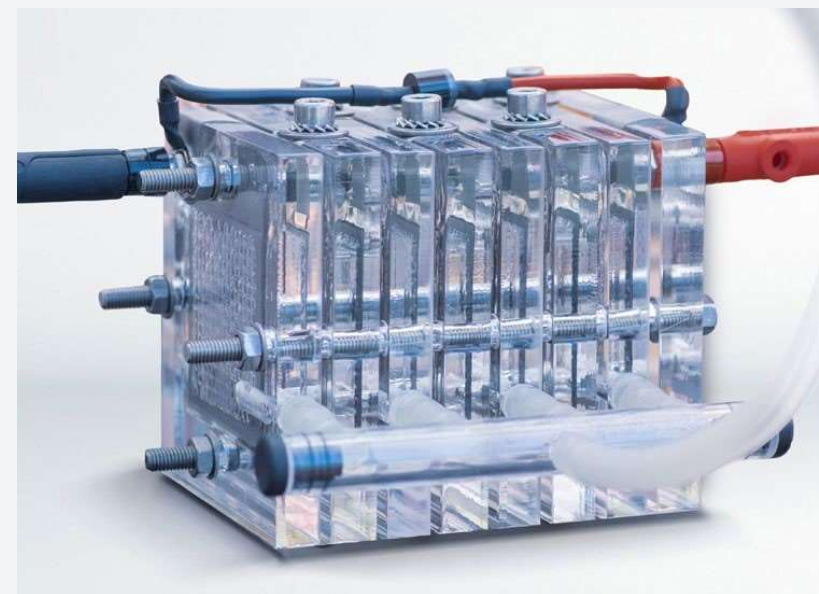
Тестова установка паливного елемента в невеликому лабораторному масштабі, як зазвичай використовується для дослідницьких цілей.
