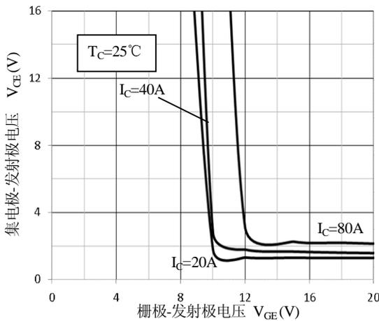
图 5. 饱和压降— $V_{GE}$  特性
