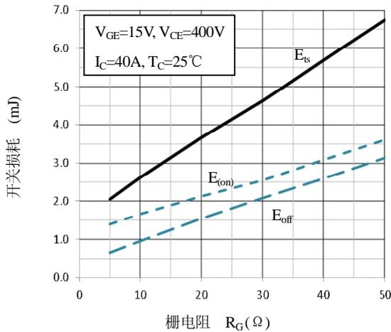
图 9. 开关损耗— $R_G$  特性
