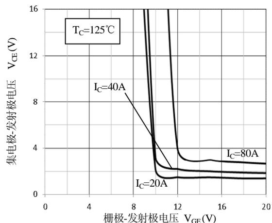
图 6. 饱和压降— $V_{GE}$  特性
