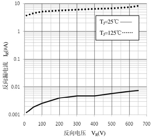
图 16. 二极管反向漏电流特性
