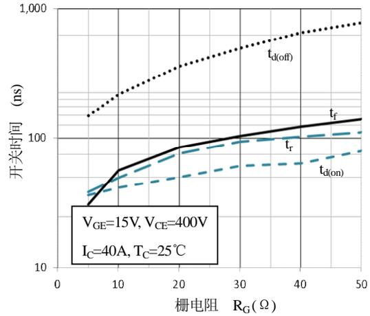
图 8. 开关时间— $R_G$  特性
