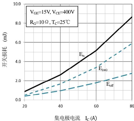
图 11. 开关损耗— $I_C$  特性
