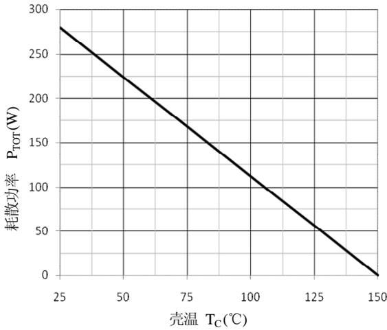
图 13. 耗散功率—壳温  $T_C$  特性
