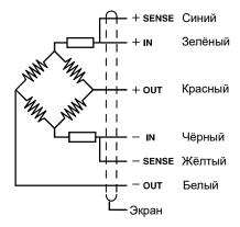
«SENSES»: два дополнительных провода служат для компенсации влияния температуры на изменение сопротивления соединительного кабеля.
