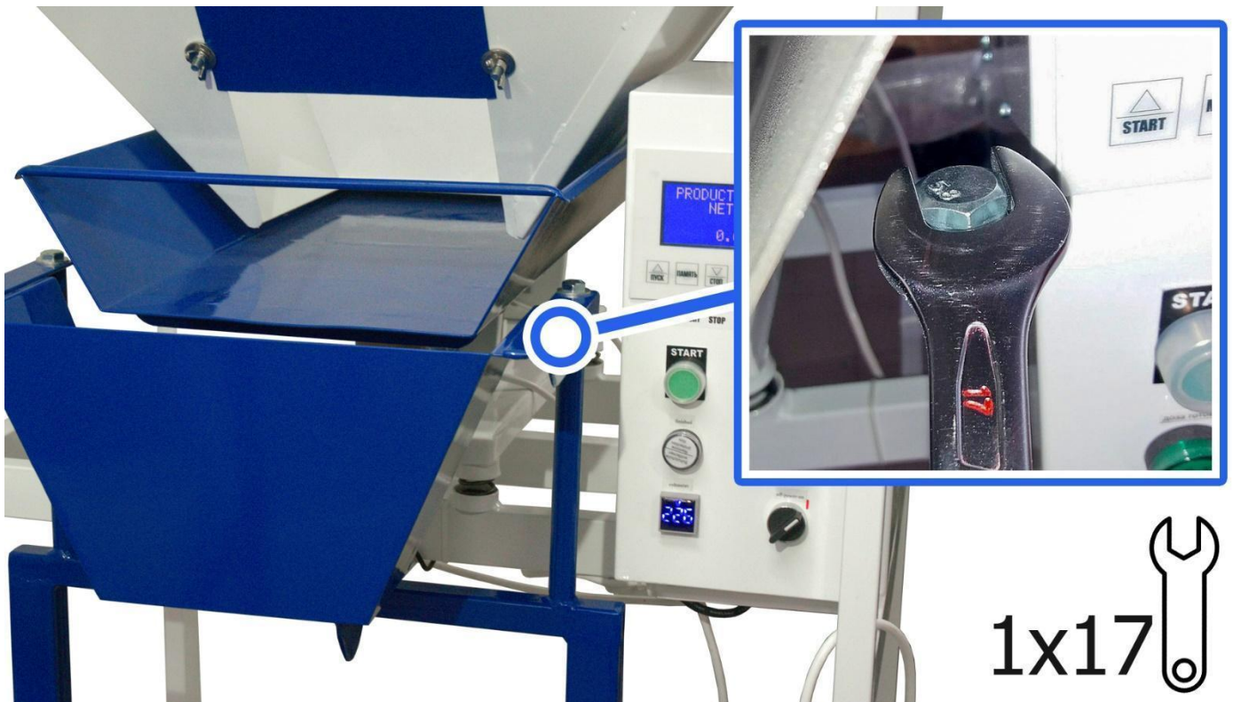
Схема 9 - Заміна лійки (лійка без зажимів)
