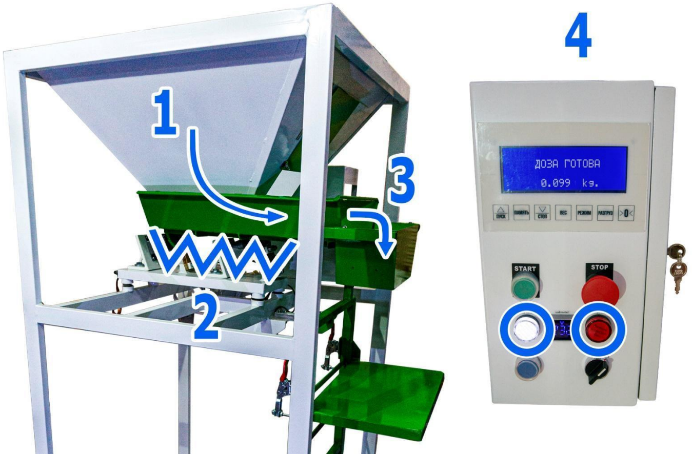
Схема 10 – Порядок роботи вагового дозатора
