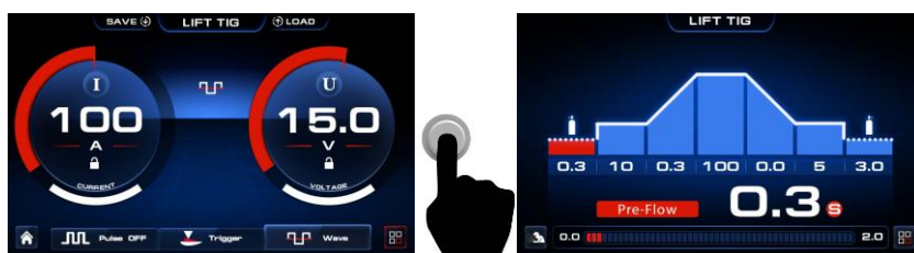
Нажмите правую кнопку ③ и войдите в интерфейс LIFT TIG
