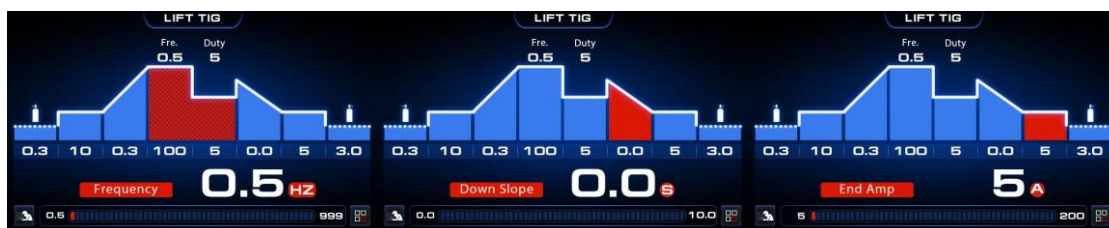
Регулювання параметрів частоти / Регулювання параметрів часу затухання струму / Регулювання параметрів кінцевого струму
