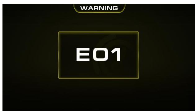
Перегрев (1-е тепловое реле)
