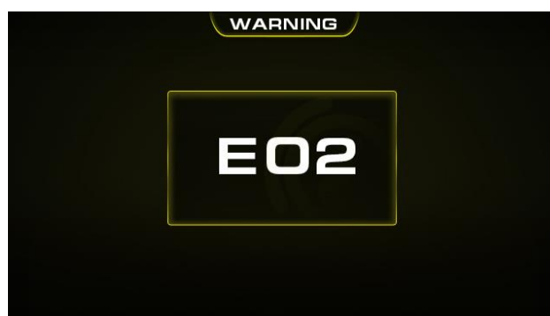
Перегрев (2-е тепловое реле)
